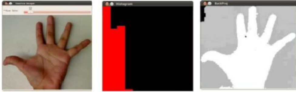
سمت چپ: تصویر ورودی - وسط: بافت‌نگار ناحیه دست - سمت راست: بک پروجکشن تصویر ورودی
